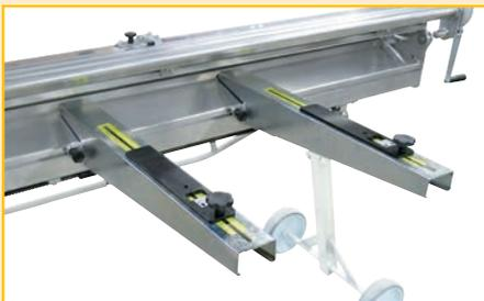
System mit freier Positionierung, um das Blech nach achtern festzuhalten. Die Anschlagarme gleiten auf der Befestigungsschiene.
