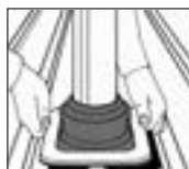
2. DEKTITE® an Profilblech anpassen und markieren.
