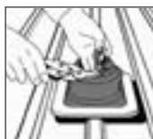
1. DEKTITE® an Rohr anpassen.
