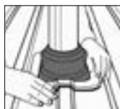
3. DEKTITE® formgenau an Profilblech anpassen.
