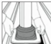
2. DEKTITE® an Profilblech anpassen und markieren.
