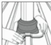
4. DEKTITE® formgenau an Profilblech anpassen.
