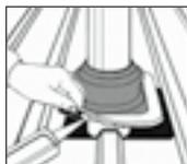
3. Dichtungsmasse auftragen.
