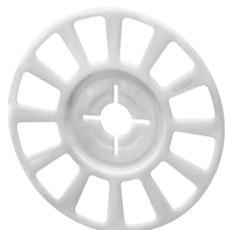
Zur konstruktiven oder statischen Verdübelung von Mineralwolle-Lamellen-Dämmplatten und Mineralwolle-Dämmplatten WLS 035 in Kombination mit Schlag- und Schraubdübeln. Durch „Aufschieben“ auf einen entsprechenden Tellerdübel gebrauchsfertig.
