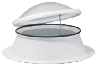
Die runde Kingspan ESSMANN Lichtkuppel, starre Ausführung, besteht aus einer hochwertigen, standardmäßig opal eingefärbten Kunststoffverglasung (3- oder 4-schalig), die direkt auf einen GFK-Aufsetzkranz geschraubt wird. Die lüftbare Ausführung besteht aus einer hochwertigen, opal eingefärbten Kunststoffverglasung, die mit einem stabilen Lüfterrahmen versehen ist, mit dem sie auf einem GFK-Aufsetzkranz befestigt wird.
