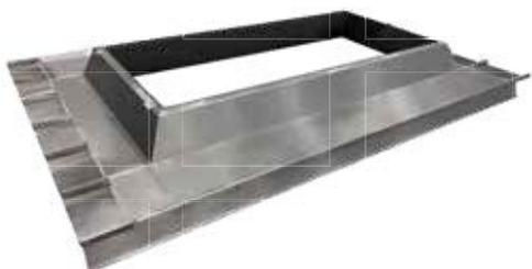
Die zweischaligen Kingspan ESSMANN ISO-Aufsetzkränze bestehen an der Außenseite aus Aluminium und an der Innenseite aus Stahl. Sie sind wärmegeklämt und in verschiedenen Bauhöhen lieferbar. Die ISO-Aufsetzkränze sind nicht brennbar und können entsprechend den europäischen Brandschutzrichtlinien ausgeführt werden. Im unteren Auflagebereich ist eine hochwertige Isolation integriert.
