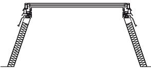
Kingspan ESSMANN Flachdachfenster mit thermisch getrenntem Stahl-Aufsetzkranz 50 cm
