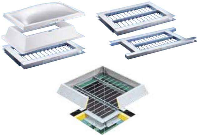
Die Kingspan ESSMANN Einbruch- und Auffangsicherung besteht aus einem verzinkten Stahlrahmen, der in verschiedenen Höhen – je nach Stärke der Wärmedämmung (80-300 mm) – geliefert wird. In ihm sind in gleichmäßigem Abstand massive Stahlstäbe eingelegt. Die statische und dynamische Konstruktion sowie die Integration in den Dachaufbau erschweren es Einbrechern, über das Dach und die Lichtkuppel in das Gebäude einzudringen.
