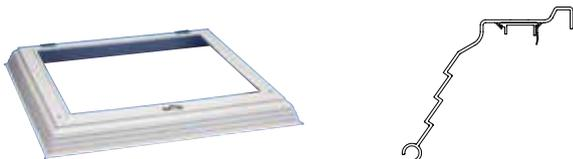
Der Kingspan ESSMANN Sicherheitsrahmen zur optionalen Kombination mit den Lichtkuppeln der classic-line besteht aus einem umlaufenden, aluverstärkten und eckverschweißten Hart-PVC-Profil, das die am Aufsetzkranz hochgeführte Dachabdichtung 10 cm überdeckt. Dies ist ein Plus an Sicherheit, da der Dachbahnenanschluss so optimal vor Witterungseinflüssen geschützt ist. Die Befestigungsscharniere für die Lichtkuppel sind auf dem Sicherheitsrahmen werkseitig komplett vormontiert.
