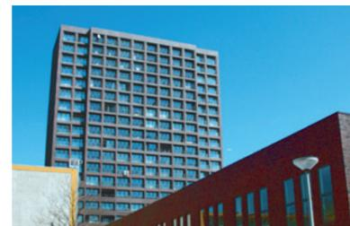
Wohnanlage mit 20 Etagen. Die Ziegelfassaden bestehen nahezu vollständig aus vorgefertigten Elementen. **ab Seite 12**
