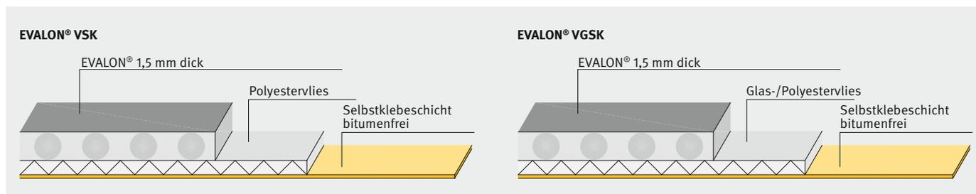
**EVALON® VSK- und VGSK**-Dach- und Dichtungsbahnen sind 25 m lang und 1,05 m breit und werden mit einem einseitigen, unbeschichteten Schweißrand hergestellt. Auf diese Weise ist die materialhomogene Verschweißung im Nahtbereich sichergestellt.
