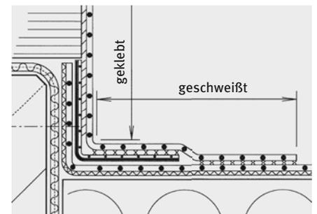
VSKA-Anschlussbahnen werden mit einem beidseitigen oder einseitigen, unbeschichteten Schweißrand hergestellt. Auf diese Weise ist die materialhomogene Verschweißung der VSKA-Anschlussbahnen mit der EVALON®-Abdichtung sichergestellt.
