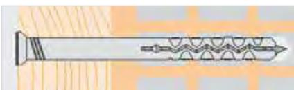
Dübel mit Senkkopfkragen für oberflächenbündige Montage
