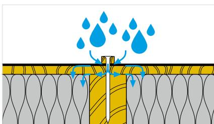
Befestigung ohne Nageldichtband
