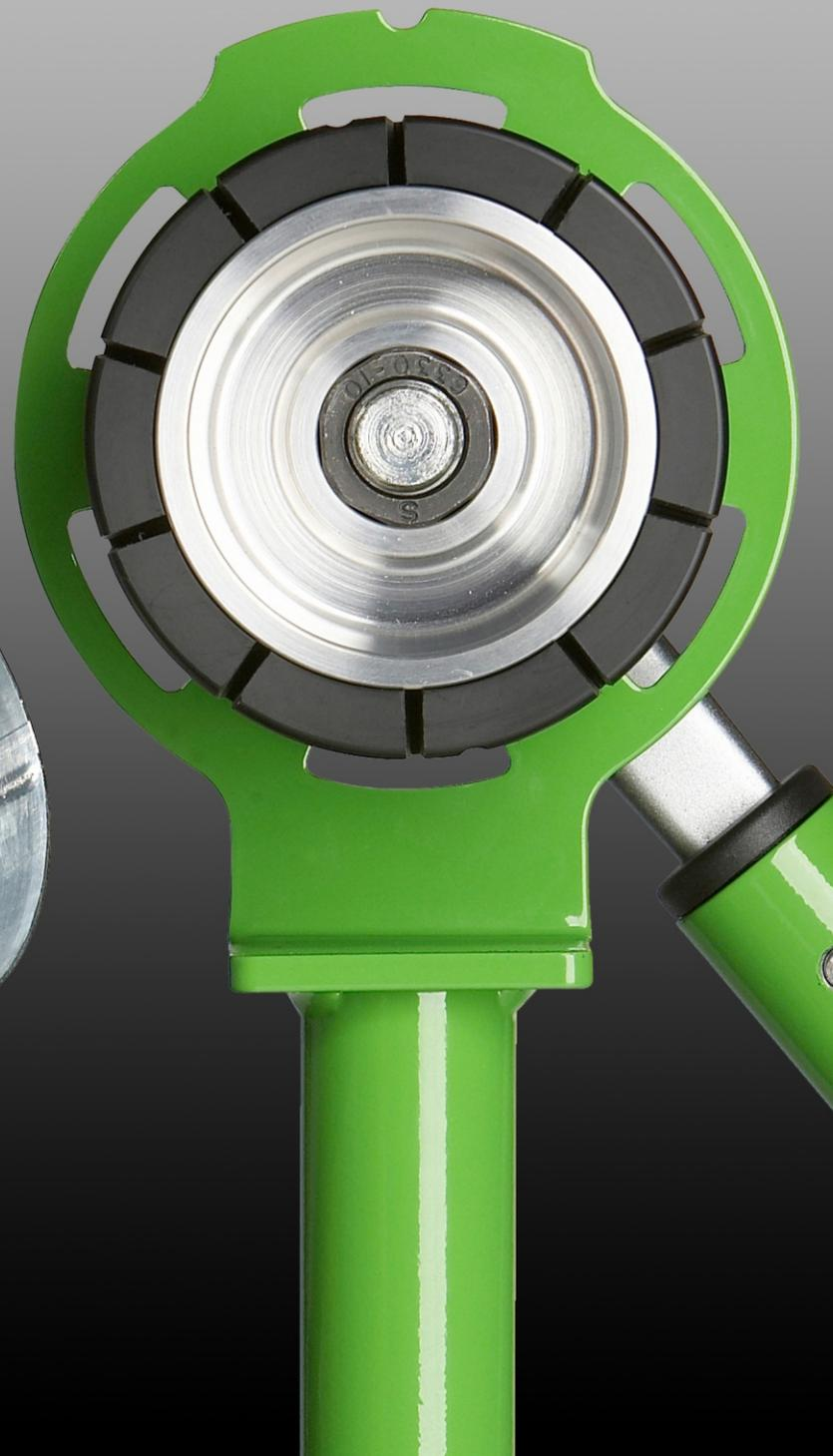
Ein Aufweitergerät für Regen-Fallrohre aus Kupfer und Zink mit einer Einstecktiefe bis 50 mm.
