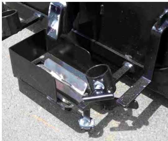
Abb. 14: Vergusschlitten mit Einsatz für schmale Fugen oder Risse
