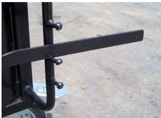
Abb. 13: Handhebel für das Anheben des Schlittens
