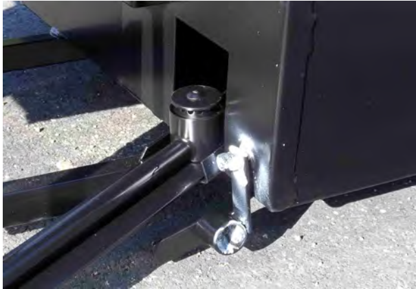
Abb. 5: Behälterbrenner, herausgezogen, bereit zum Zünden
