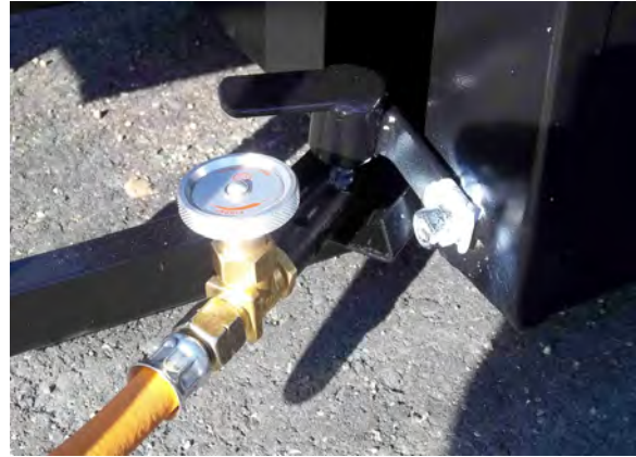
Abb. 6: Brennerventil, Behälterbrenner in Betriebsstellung mit Sicherung
