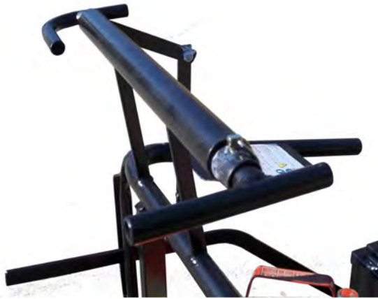
Abb. 15: Drehhebel (oben), Handhebel (unten) zur Dosierung der Vergussmasse
