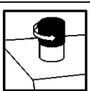
Przed uruchomieniem łuparki do drewna należy odpowietrzyć instalację hydrauliczną. (patrz „Włączenie urządzenia”)
