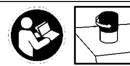
Před uváděním štípačky na palivové dříví odvzdušněte hydraulické zařízení. (viz „Uvedení do provozu“)
