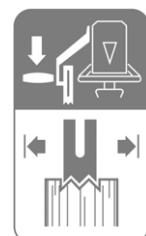
3. **17** Houd de linker bedieningshendel (12) ingedrukt en druk de rechter bedieningshendel (13) halverwege naar beneden, om de stam eerst langzaam te splijten.
