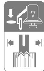
**⚠** Fiksirno čeljust ustrezno nastavite glede na višino debla. Krilati vijak (A) odpustite in namestite fiksirno čeljust.
