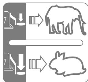
Hög klyvningshastighet med lägre klyvningskraft för klyvning av normalt hårdta trästammer eller för slutet av klyvningsprocessen → betjäningsspankens nedersta position.
