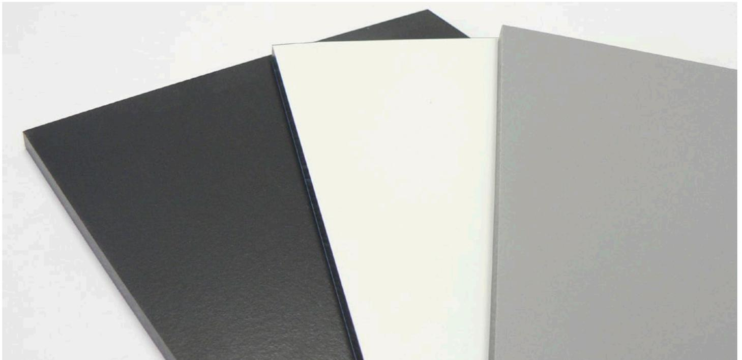
UNIPLAN – die preiswerten duroplastischen Hochdrucklamine (HPL = High Pressure Laminates), sind für den Innen- sowie den geschützten Außenbereich geeignet. Sie weisen eine leicht zu reinigende, harte Oberfläche auf. UNIPLAN Baukompaktplatten lassen sich einfach mit hartmetallbestückten Werkzeugen zur Holzbearbeitung sägen, bohren und fräsen.
