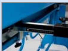
Hinterer Tiefenanschlag mit Gleitschiene
